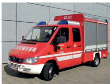
Kleinrüstfahrzeug Mercedes Sprinter 416 CDI 156 PS, Baujahr: 2005
